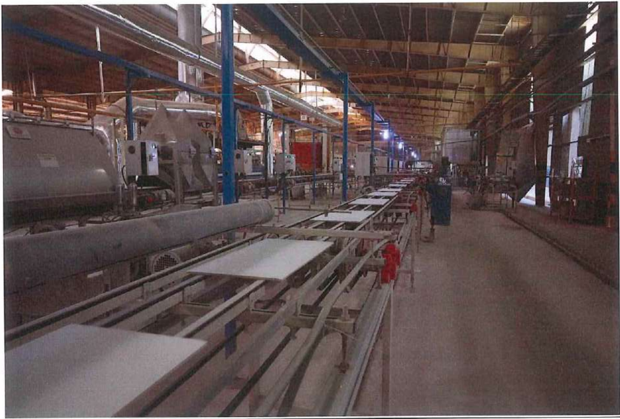
Hệ thống băng tải vận chuyển gạch mộc trên dây chuyền tráng men và trang trí
